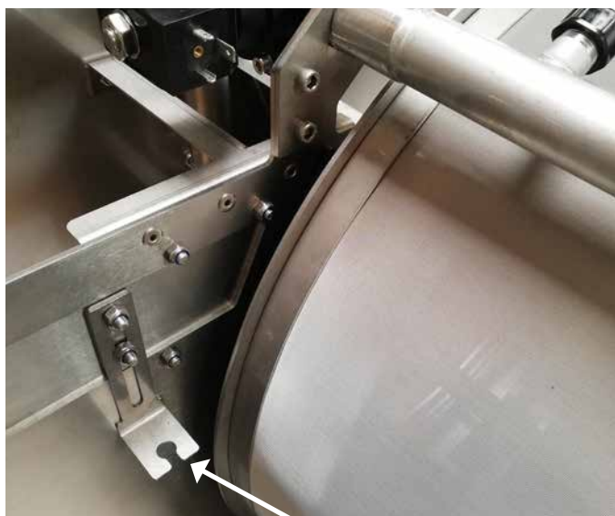
Filtres sans chambre bio : Montage du l'interrupteur flottant dans la zone d'eau propre à l'extérieur du tambour
